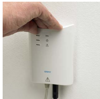
Enfoncer le boîtier vers le bas pour entendre un clic
