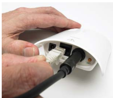
Câble du système d'appel malade en contact sec
